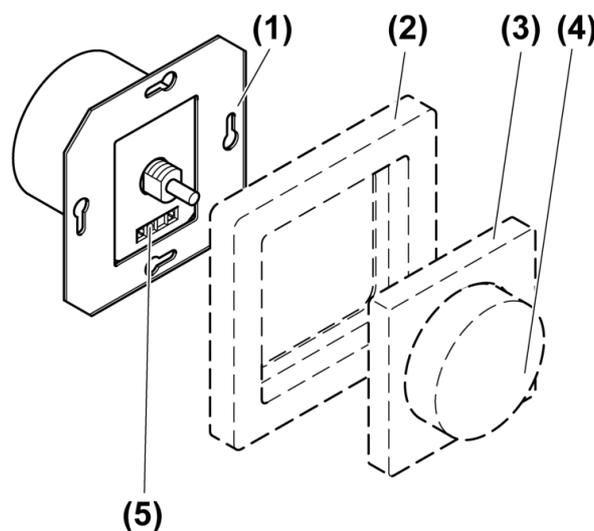
Bild 1: Geräteaufbau
